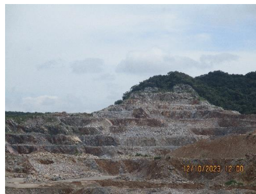
รูปที่ 2-4 ลักษณะการทำเหมืองแบบขั้นบันได เหมืองแร่หินปูน
